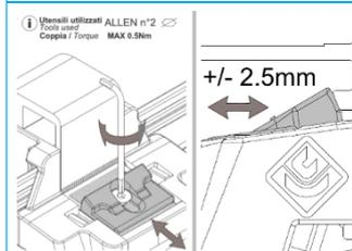
Son mécanisme à glissière, permet d'effectuer le réglage ( $\pm 2,5$  mm) avec une petite clef hexagonale, en permettant l'adaptation à chaque typologie de profilé.
