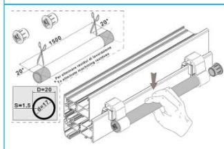
En plus, grâce aussi au corps de manœuvre profilé avec diamètre 20 mm, il est possible mouvenner plus cliquets dans le même temps avec l'aide d'un tubulaire standard de jonction.
