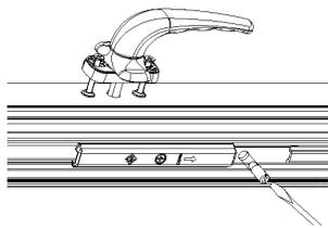
**C.** Dotato di carter esterno che riveste le leve di trascinamento del sistema di movimentazione, garantendo la sicurezza dell'accessorio oltre ad una maggiore pulizia estetica dell'infisso.
