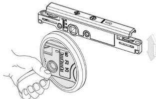
**B.** Ingombro regolabile da 15 a 35 mm, grazie ad un nuovo sistema a molle con guide di riferimento e al cinematisimo di rimando del movimento martellina (entrambi brevettati), che consentono l'installazione anche su profili maggiorati o a taglio termico;
